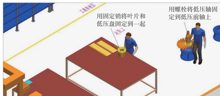
图12 转子零件装配工艺仿真场景
